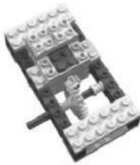
图 3.5 可方便拆除马达的装置
