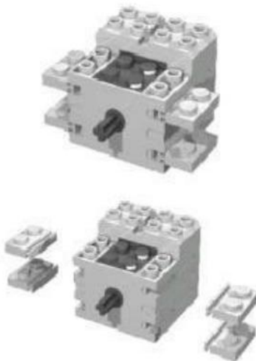
图 3.4 带有导轨的 1 \times 2 的板便于固定马达
