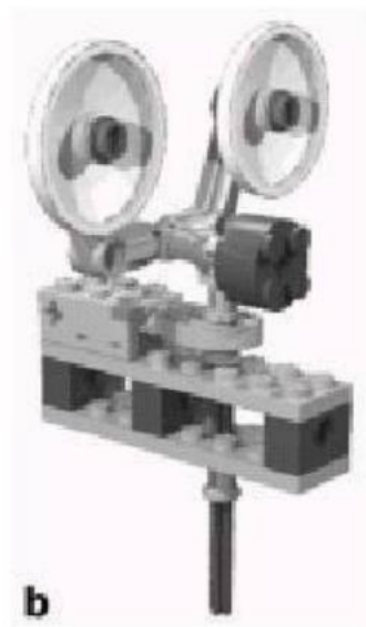
图 4.4 用触动传感器定位
